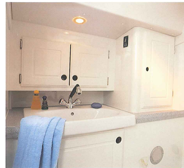
En ny toalett- och duschinredning. Helt vita skott med matchande handfatsskiva och duschtrall i Corian.
